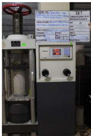
Control de calidad – Rotura de testigos cilíndricos
