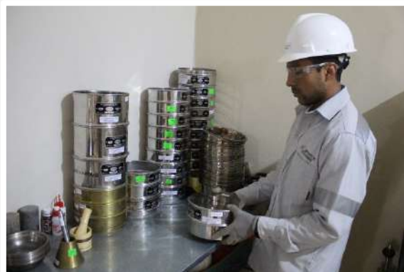
Ejecucion de ensayos de granulometría
