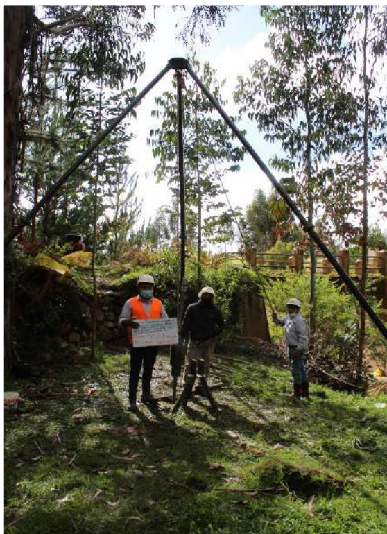
Ensayos SPT Pontones
