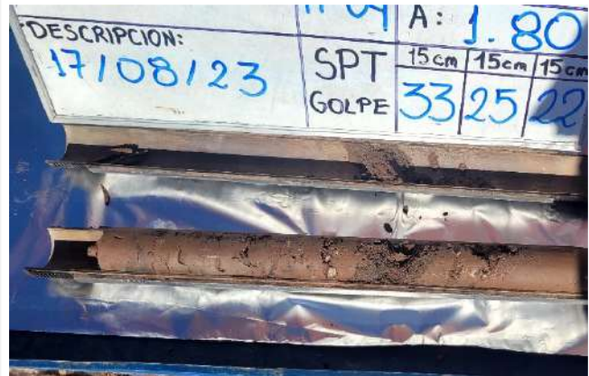
Exploraciones geotécnicas con SPT y recuperación de muestras.
