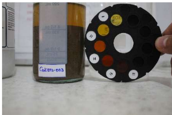
Pruebas de impurezas en agregados
