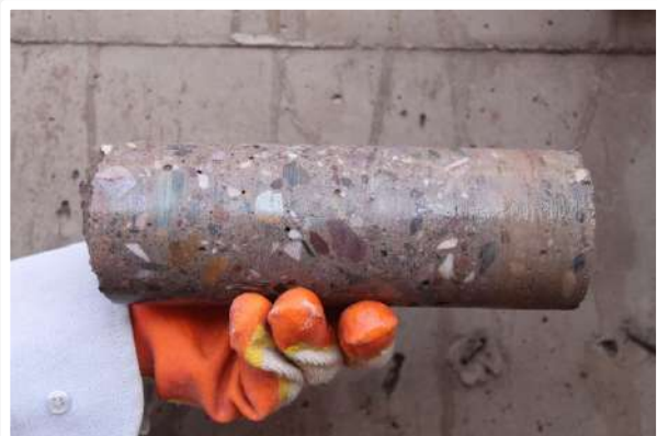
Recuperación de testigos de concreto por perforación diamantina
